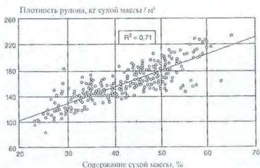
График А. Этот график показывает, что окончательная плотность рулона зависит в большей степени от содержания сухой массы. При 50-процентном содержании сухой массы плотность рулона составляет около 150-200 кг сухой массы/м<sup>3</sup> и напрямую зависит от техники вождения.
